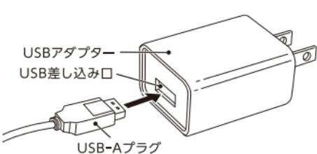
2. USBアダプターのUSB差し込み口にUSB-Aプラグを差し込み、USBアダプターをコンセントに差す。
